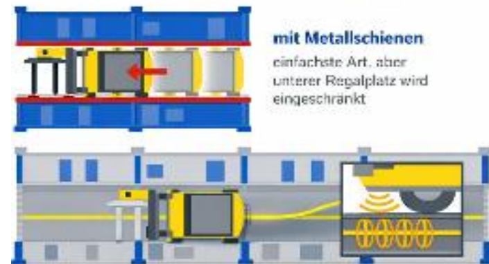
mit Induktionsdraht für große Regalgänge und Hochregale wirtschaftlicher genau mittig in den Boden verlegt
