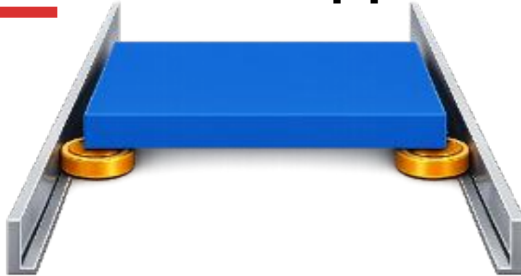
Mit Rollen Stapler sicher im Schmalgang bewegen
